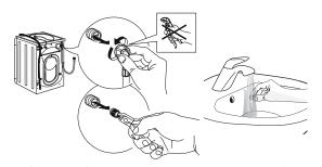
4. 裝回濾網並將進水喉擰回機上。不要使用工具來連接進水喉。打開水龍頭並確認各連接位均完全不漏水。
